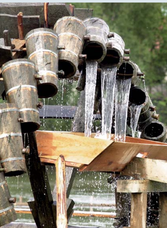
Gewitzte Energietechnik: Die Schöpfradtechnik an der Erlanger Regnitz ist über 500 Jahre alt. Foto: Harald Hofmann
