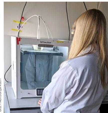
**Verschlüsse für Atemschutzmasken** werden an der Universität Erlangen-Nürnberg mit 3D-Druckern hergestellt, hier am Lehrstuhl für Biomaterialien.
