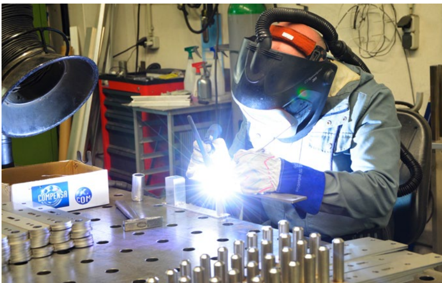
Ein Gmöhling-Mitarbeiter beim Schweißen von Aluminium-Teilen.
